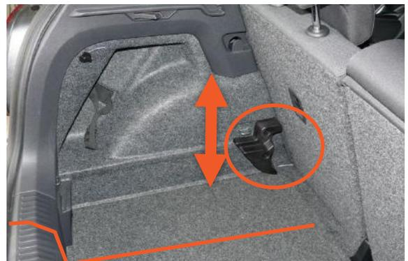
*Boden niedriger als den Heckklappenplatte.*
